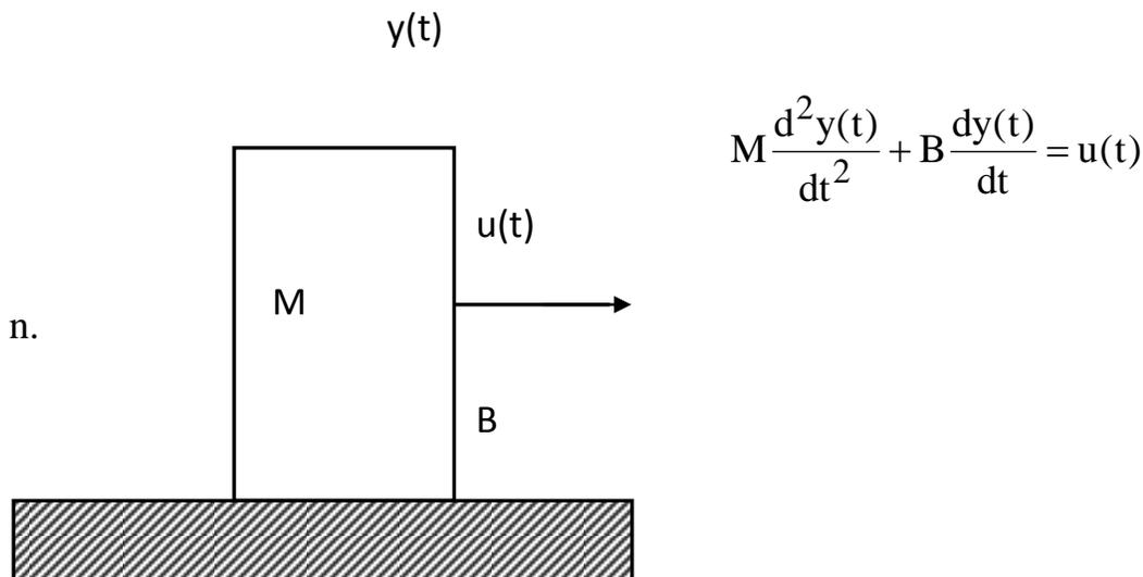
Orientiamo il sistema scegliendo come ingresso la forza  $u(t)$  e come uscita lo spostamento della massa  $y(t)$ . Per determinare l'uscita è necessario integrare tale equazione differenziale, il che richiede la conoscenza dell'andamento dell'ingresso in tutto l'intervallo  $[0,t]$  e la conoscenza della posizione iniziale e della velocità iniziale, ovvero di  $y(0)$  e  $y'(0)$ . In questo caso il sistema è dinamico del secondo ordine.
