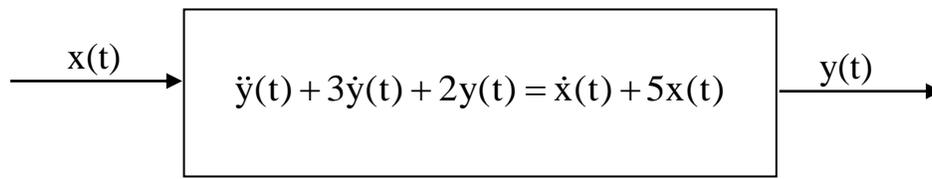
Noto l'ingresso  $x(t)$ , l'incognita dell'equazione differenziale è la funzione  $y(t)$ . Eseguire questo calcolo vuol dire risolvere l'equazione differenziale del sistema per quel particolare andamento della funzione di ingresso  $x(t)$ .
