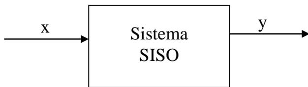
Un modello matematico (o un sistema) si dice *lineare* quando soddisfa la proprietà di *sovrapposizione degli effetti*. In altre parole, considerato il sistema in figura, detti  $x_1(t)$  e  $x_2(t)$  due ingressi qualsiasi e dette  $y_1(t)$  e  $y_2(t)$  le rispettive uscite del sistema, applicando in ingresso al sistema il segnale  $x(t) = ax_1(t) + bx_2(t)$  essendo  $a$  e  $b$  due numeri reali qualsiasi, la risposta del sistema vale  $y(t) = ay_1(t) + by_2(t)$ .
