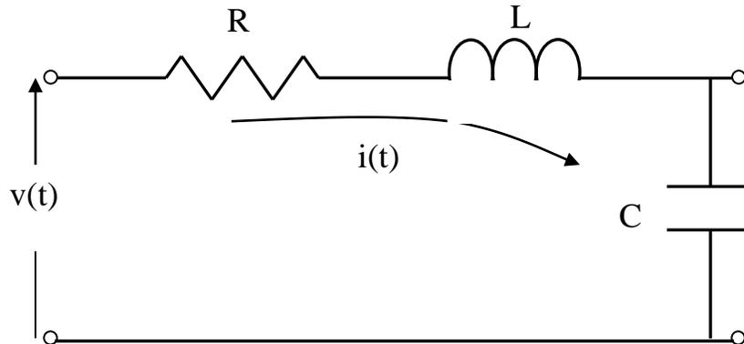
Evidentemente l'orientamento del sistema, ovvero l'individuazione degli ingressi e delle uscite dipende dalle scelte del progettista. In effetti ciascuna delle due variabili  $i(t)$  e  $v(t)$  può assumere entrambi i ruoli. Se ad esempio si collega ai morsetti del circuito un generatore di tensione  $v(t)$  si può studiare l'andamento della corrente del circuito rispetto a  $v(t)$ . In tal caso dunque  $v(t)$  è l'ingresso e  $i(t)$  l'uscita del sistema.
