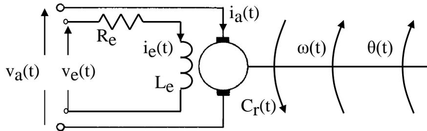
Le variabili di interesse sono la tensione e la corrente di armatura  $v_a$  e  $i_a$ , la tensione e la corrente di campo (o eccitazione)  $v_e$  e  $i_e$ , la coppia resistente all'albero  $C_r$ , la velocità e la posizione angolare del rotore  $\omega$  e  $\theta$ .
