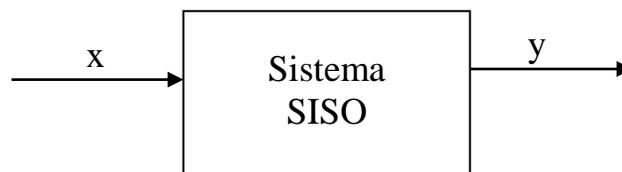
Un *modello matematico statico* presuppone che il valore corrente dell'uscita dipenda solo dal valore corrente dell'ingresso. Ciò accade raramente in natura. Pertanto un modello statico di un sistema che non è statico ne individua una visione approssimata che non fornisce alcuna informazione sul *regime transitorio* del sistema modellato, cioè non fornisce indicazioni sull'andamento nel tempo delle uscite durante il passaggio da uno stato stazionario ad un altro.
