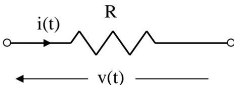
Un classico esempio di un sistema statico è il resistore avente resistenza  $R$  in figura. Scegliendo come ingresso la tensione applicata  $v(t)$  e come uscita la corrente che scorre nella resistenza  $i(t)$ , si ottiene la caratteristica statica del sistema:
