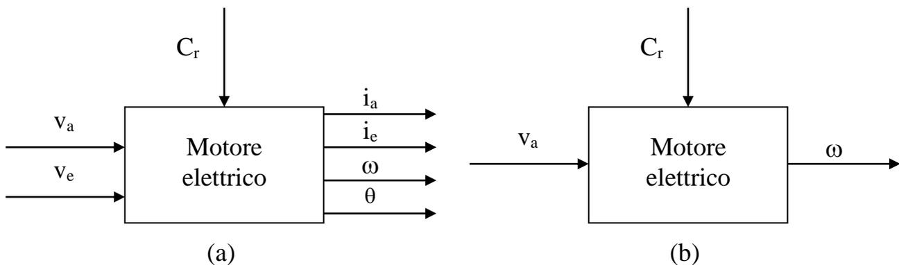
È anche possibile una rappresentazione del sistema di tipo SISO (Single Input Single Output), ossia con un ingresso, un disturbo e una uscita se si suppone di considerare  $v_e$  costante ( $v_a$  costante) e si sceglie ad esempio la sola velocità angolare come uscita. Il sistema motore elettrico in questo caso si dice controllato in armatura (eccitazione).
