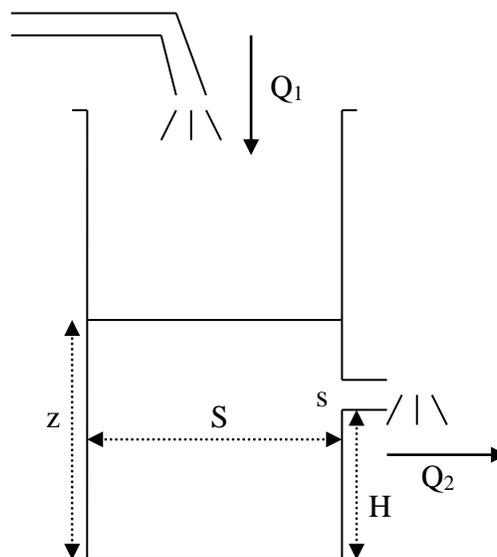
Si consideri il sistema idraulico in figura, costituito da un serbatoio che, attraverso un condotto in ingresso, viene riempito di liquido, con portata  $Q_1(t)$  [ $\text{m}^3 \text{s}^{-1}$ ] e flusso  $q_1(t)$  [ $\text{m s}^{-1}$ ]. Il liquido fuoriesce da un condotto di uscita ad altezza  $H$ , con portata  $Q_2(t)$  [ $\text{m}^3 \text{s}^{-1}$ ] e flusso  $q_2(t)$  [ $\text{m s}^{-1}$ ].
