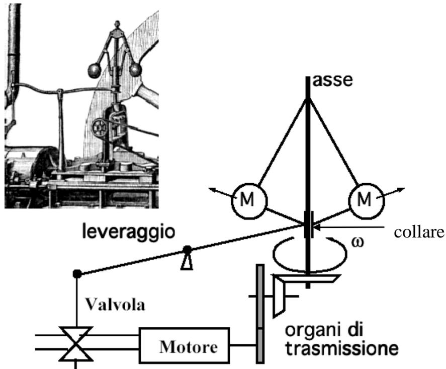
L'obiettivo di questo sistema di regolazione è mantenere costante (controllare) la velocità angolare del motore (uscita) per mezzo della portata di vapore (ingresso) immesso attraverso la valvola a farfalla.
