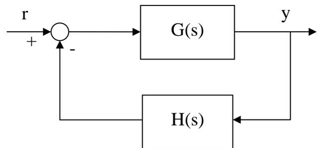
Il sistema è chiuso in retroazione non unitaria. Si determini il diagramma di Nyquist del sistema e si studi la stabilità in anello chiuso applicando il teorema di Nyquist.
