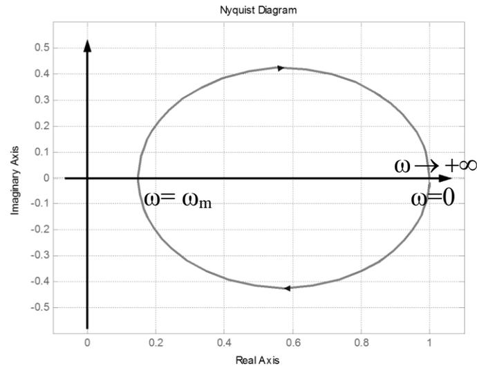
Il diagramma relativo all'intervallo di pulsazioni negative si ottiene ribaltando, rispetto all'asse delle ascisse, quello ottenuto, quindi il diagramma resta invariato ma viene percorso due volte per  $\omega \in ]-\infty, +\infty[$ .
