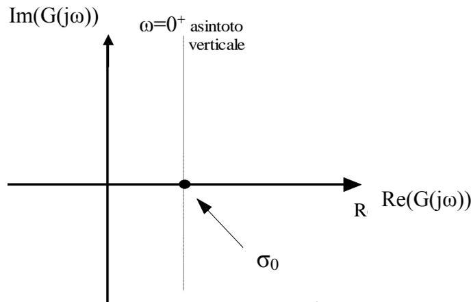
La figura fa chiaramente riferimento al caso in cui  $\sigma_0 > 0$  e al punto  $\omega=0^+$  corrisponde il punto  $\sigma_0 + j\infty$  (ovvero risulta  $\lim_{\omega \rightarrow 0^+} |GH(j\omega)| = +\infty$  e  $\lim_{\omega \rightarrow 0^+} \angle GH(j\omega) = +\frac{\pi}{2}$ ), ma può evidentemente anche risultare che sia  $\sigma_0 < 0$  e/o che e al punto  $\omega=0^+$  corrisponda il punto  $\sigma_0 - j\infty$ .
