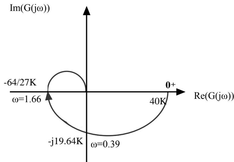
Il diagramma relativo all'intervallo di pulsazioni negative si ottiene ribaltando, rispetto all'asse delle ascisse, quello ottenuto. Concludiamo che il diagramma polare qualitativo di  $G(j\omega)$  è il seguente.
