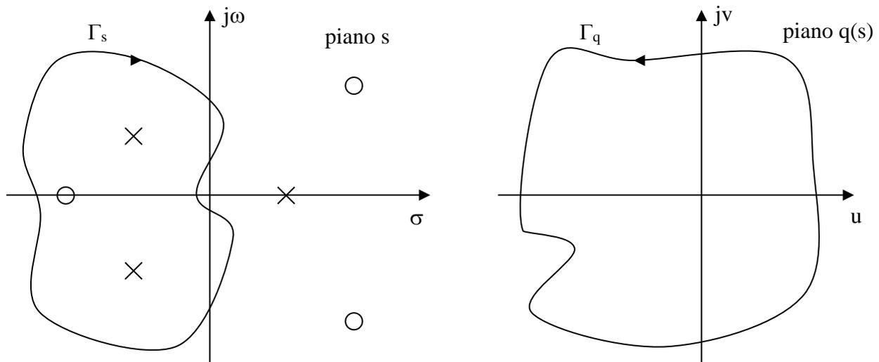
Il criterio di Nyquist discende dal principio dell'argomento e fa uso di un particolare contorno  $\Gamma_s$  sul piano  $s$ , detto percorso di Nyquist, costituito dall'intero asse immaginario chiuso in senso orario da una semicirconfenza di raggio  $R$  infinito disposta nel semipiano destro, come in figura.
