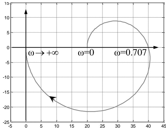
Il diagramma relativo all'intervallo di pulsazioni negative si ottiene ribaltando, rispetto all'asse delle ascisse, quello ottenuto. Concludiamo che il diagramma polare qualitativo di  $G(j\omega)$  è il seguente.
