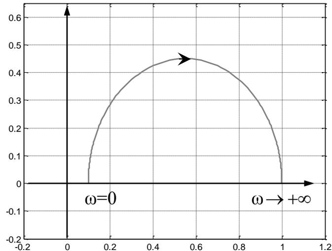
Il diagramma relativo all'intervallo di pulsazioni negative si ottiene ribaltando, rispetto all'asse delle ascisse, quello ottenuto. Concludiamo che il diagramma polare qualitativo di  $G(j\omega)$  è il seguente.
