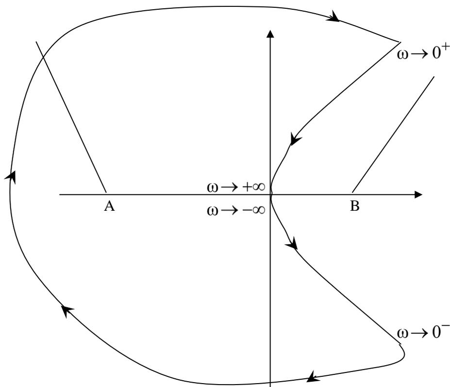
Osserviamo che il sistema in anello aperto ha due poli nell'origine, dunque la chiusura all'infinito è formata da due mezzi giri in senso orario da  $\omega \rightarrow 0^-$  a  $\omega \rightarrow 0^+$ .
