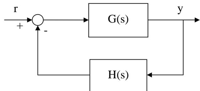
Si determini il diagramma di Nyquist del sistema e si studi la stabilità in anello chiuso applicando il teorema di Nyquist.
