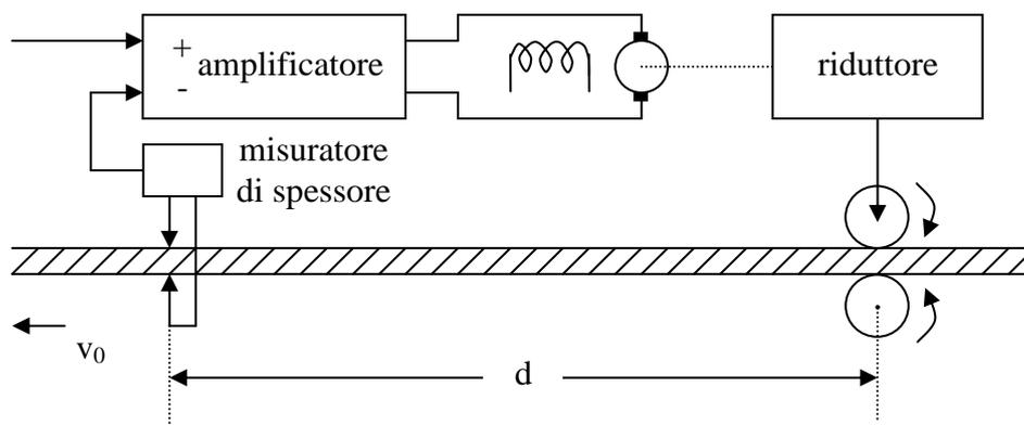
Poiché la funzione di trasferimento del gruppo misuratore-amplificatore-motore riduttore è la seguente:
