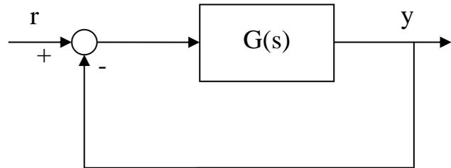
Il sistema è chiuso in retroazione unitaria. Si determini il diagramma di Nyquist del sistema e si studi la stabilità in anello chiuso applicando il teorema di Nyquist.
