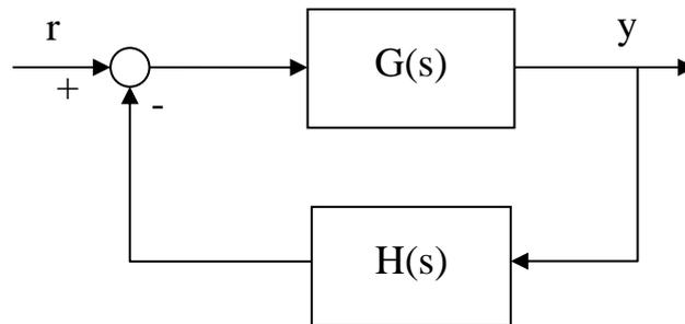
Ipotesi: Sia  $GH(s)$  la funzione di trasferimento di anello, razionale fratta e propria, a coefficienti reali, del generico sistema in figura. Sia  $P$  il numero di poli del sistema in anello aperto (ovvero di tale funzione di trasferimento di anello) che sono a parte reale positiva. Sia  $Z$  il numero delle radici dell'equazione caratteristica (ossia di poli in anello chiuso del sistema) a parte reale positiva, incognito.
