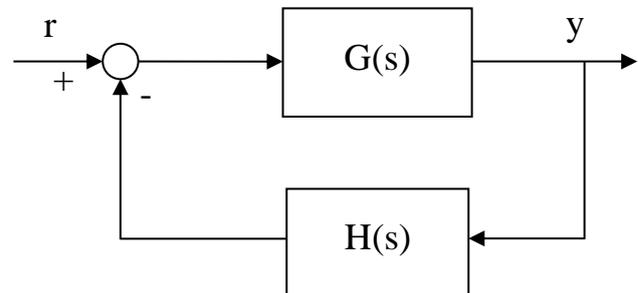
Il sistema è chiuso in retroazione non unitaria. Si determini il diagramma di Nyquist del sistema e si studi la stabilità in anello chiuso applicando il teorema di Nyquist.
