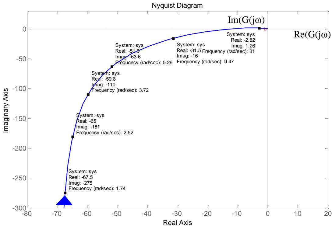
Come si vede dai precedenti esempi, un generico punto del diagramma polare di una funzione di risposta armonica  $G(j\omega)$  (retroazione unitaria) o  $GH(j\omega)$  (retroazione non unitaria) mostra quindi come varia nel piano di Gauss il punto complesso  $GH(j\omega)$  al variare della pulsazione  $\omega$ .
