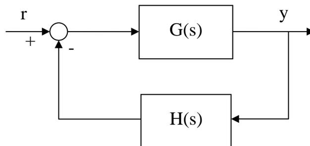
In particolare, sia il criterio di Routh che il metodo del luogo delle radici permettono di investigare la stabilità relativa di un sistema del tipo in figura nel dominio della variabile complessa  $s$ , indicando la distanza dei poli in anello chiuso dall'asse immaginario.
