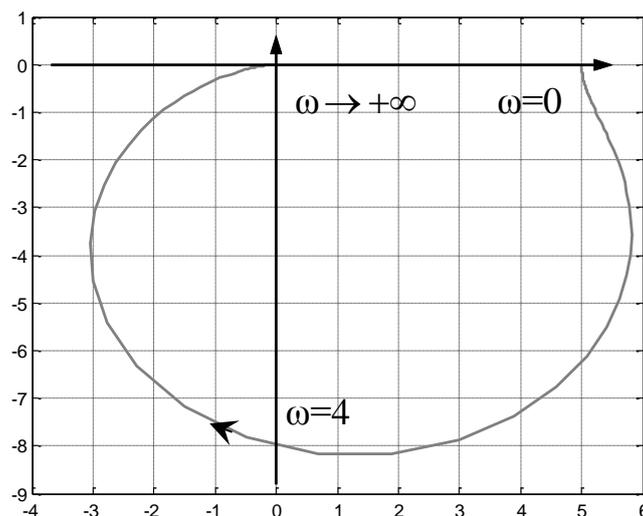
Il diagramma relativo all'intervallo di pulsazioni negative si ottiene ribaltando, rispetto all'asse delle ascisse, quello ottenuto. Concludiamo che il diagramma polare qualitativo di  $GH(j\omega)$  è il seguente.
