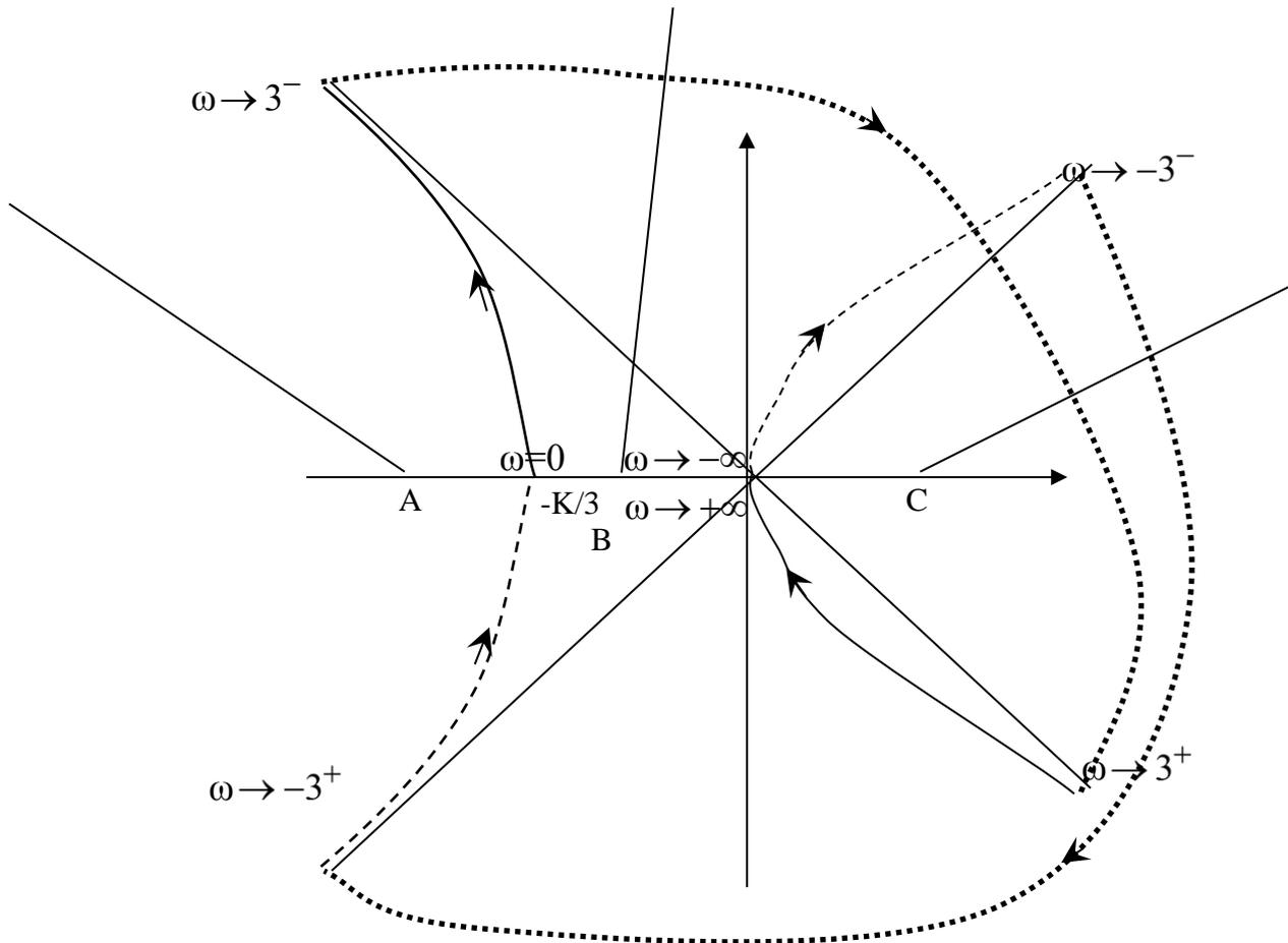
Osserviamo che il sistema in anello aperto ha una coppia di poli immaginari puri, dunque la chiusura all'infinito è formata da due mezzi giro in senso orario, uno da  $\omega \rightarrow 3^-$  a  $\omega \rightarrow 3^+$  e l'altro da  $\omega \rightarrow -3^-$  a  $\omega \rightarrow -3^+$ .
