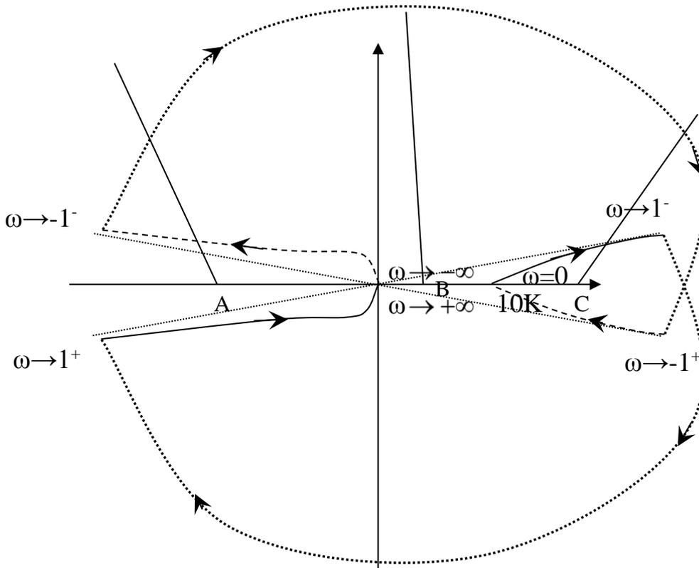
Osserviamo che il sistema in anello aperto ha una coppia di poli immaginari puri, dunque la chiusura all'infinito è formata da due mezzi giro in senso orario, uno da  $\omega \rightarrow 1^-$  a  $\omega \rightarrow 1^+$  e l'altro da  $\omega \rightarrow -1^-$  a  $\omega \rightarrow -1^+$ .
